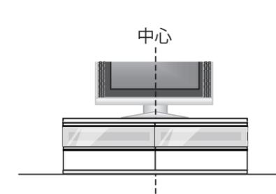
表示されているローボードの天板耐荷重は天板の中心にTVを設置した場合の耐荷重となります。
